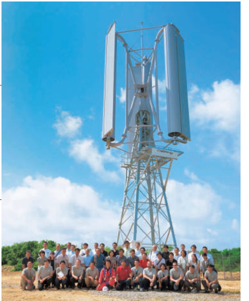
石垣島の垂直軸型マグナス風力発電機の試験機とチームメンバー The team members at the Ishigakijima vertical axis Magnus wind turbine testing equipment
